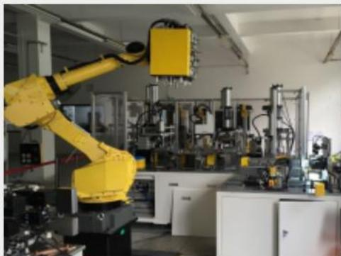
汽车连接器裁切折弯自动注塑线
