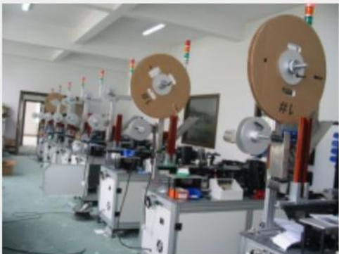
汽车连接器组装生产线
